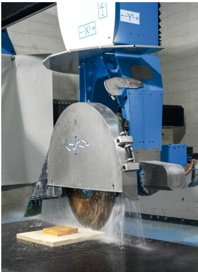
Die Firma Schulz stellt ihr fünfachsiges CNC-Bearbeitungszentrum T958 auch Steinmetzbetrieben für die Fertigung zur Verfügung.
