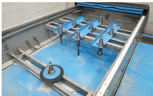
Das durchdachte Magazin des Bearbeitungszentrums gewährleistet einen effizienten Werkzeugwechsel für eine variable Produktion.
