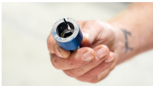
Die speziellen Materialien im Feuerungsbau mit teils sehr hohen Dichten beanspruchen die Fräsfinger vergleichsweise stark.
