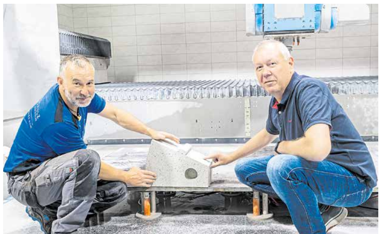
Holger Schulz (r.), Firmenchef in zweiter Generation, und Karl Röder (Techniker und Baustellenleiter) vor dem Steinbearbeitungszentrum. Die CNC-gesteuerte Anlage fräst unter anderem Formsteine, die von Kunden über den 3D-Konfigurator im Webshop nach individuellen Maßen entworfen wurden.
